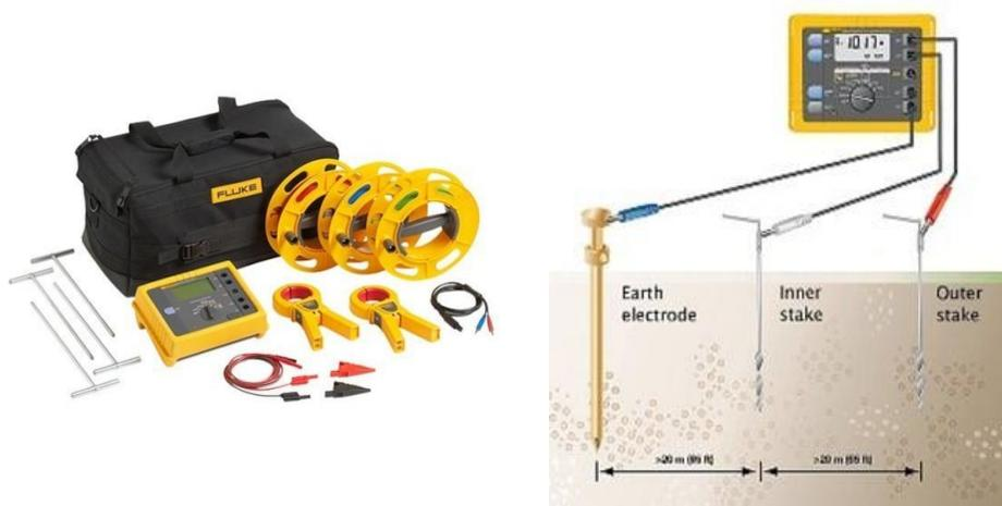
Mesure de résistance de terre multifonction
